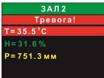
Также в случае превышения одного из порогов выдается звуковой сигнал. Для сброса сигнала нажать любую кнопку. Если после сброса снова произойдет превышение порога, то звуковой сигнал выдается вновь. Пользователь должен подтвердить каждое событие превышения порога.
